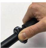
Am Rohloff E-14 Lenker-Taster beide Tasten (+/-) gleichzeitig drücken (ggf. die Tasten einzeln mit zwei Fingern drücken) und **gedrückt** halten!
