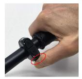
Anschließend M-Taste am Rohloff E-14 Lenker-Taster drücken und so lange gedrückt halten (ca. 8 Sekunden) bis das Bosch eBike Antriebssystem automatisch abschaltet (keine Anzeige im Display).
