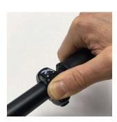
Am Rohloff E-14 Lenker-Taster weiterhin beide (+/-) Tasten gedrückt halten, bis an der Rohloff E-14 Schalteinheit die Autokalibrierung beginnt (ca. 8 Sekunden).
