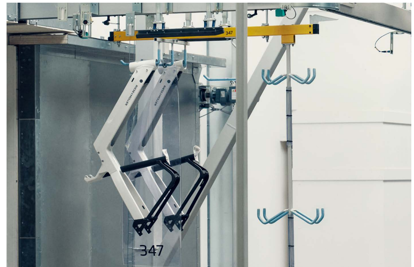
Rahmen werden über das OCS-Transportsystem befördert. Zwei Photovoltaikanlagen produzieren nahezu 100 % des am Standort verbrauchten Stroms.
