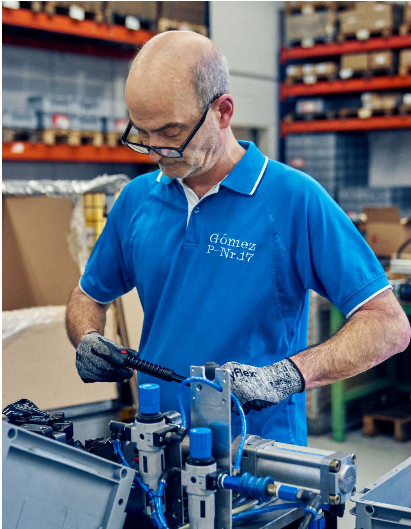
Hinterbauständer werden an einer eigens konstruierten Vorrichtung montiert.
