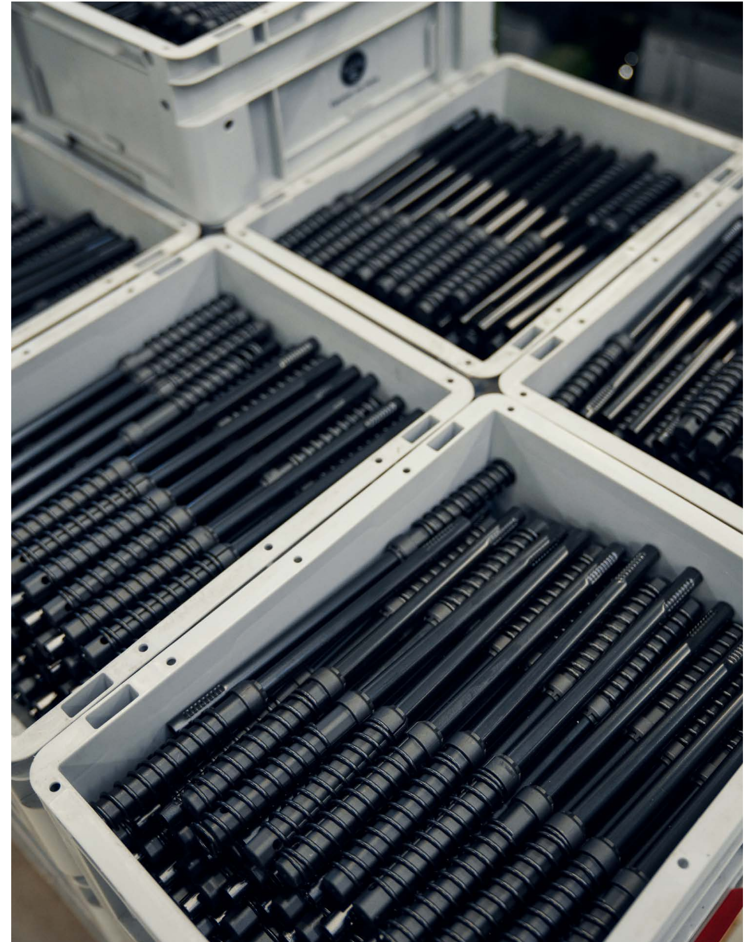
Die Baugruppe „Ständer, Röhre, Feder“ für Hinterbauständer.
