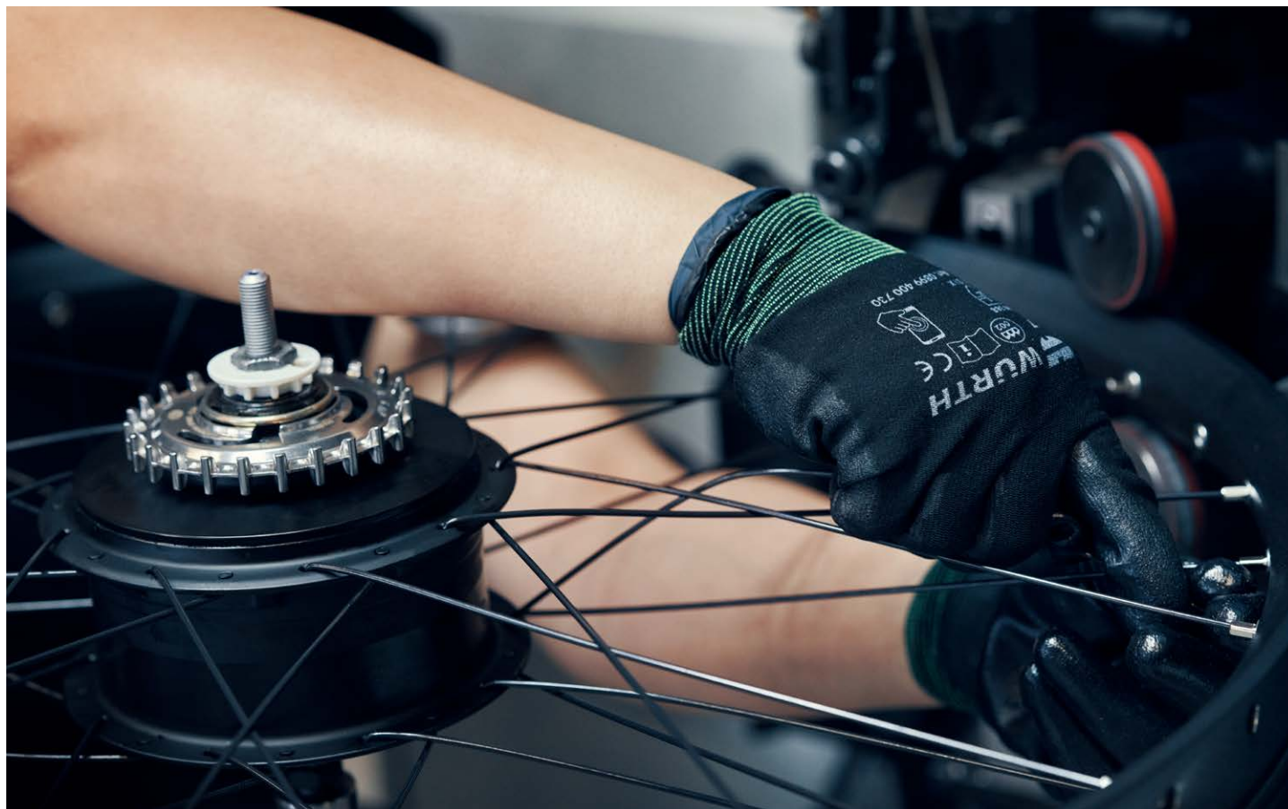
Lafräder sind Handarbeit und werden manuell eingespeicht.
