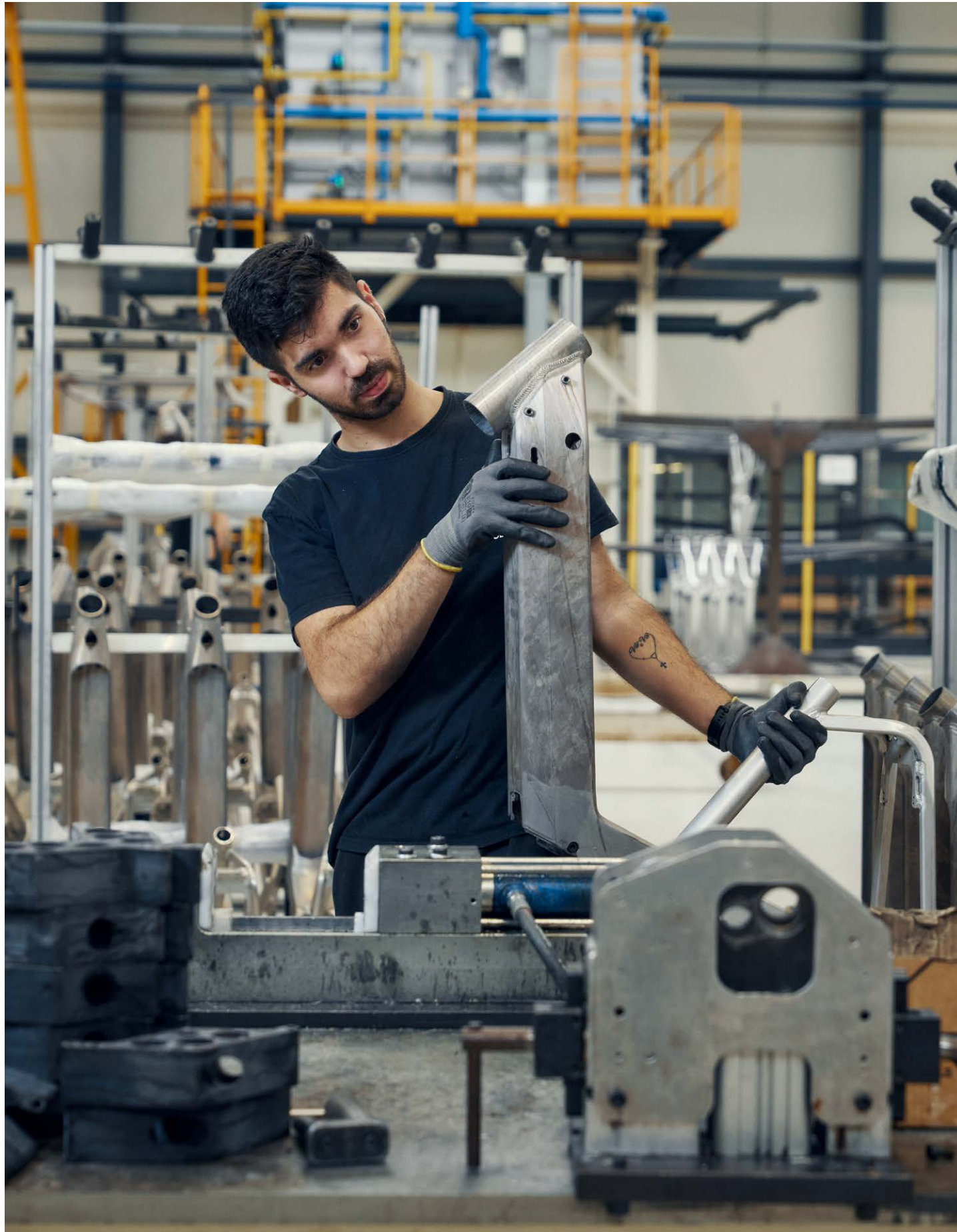
Nach der Wärmebehandlung müssen die Rahmen präzise ausgerichtet werden.
