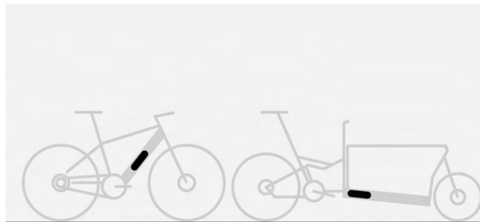
Batería integrada en el cuadro
