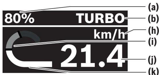
(a) Niveau de charge de la batterie de VAE (configurable)
